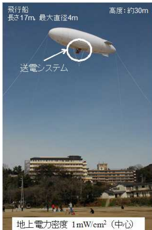
図1 飛行船からのマイクロ波電力・情報伝送送信デモ実験の写真
