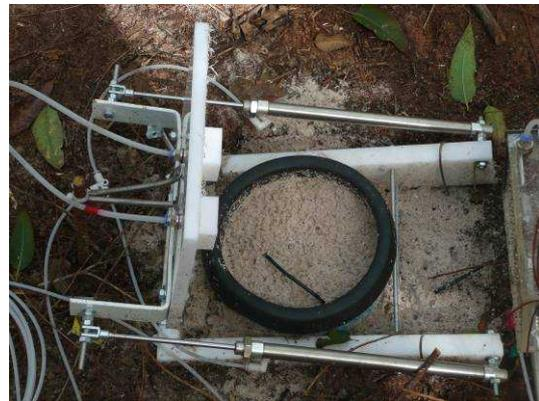
写真 3. 幹呼吸測定用チャンバー(左)、根呼吸測定用チャンバー(右)
