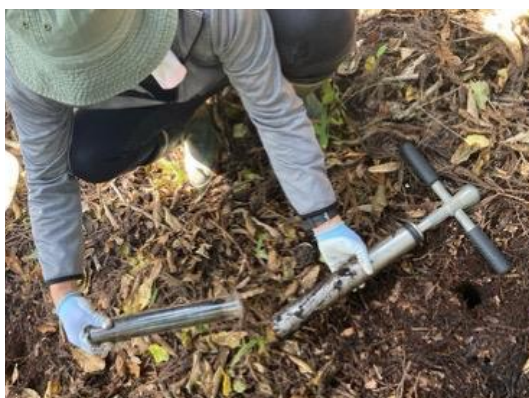
図-4 ライナー採土器による土壌の不攪乱採取
