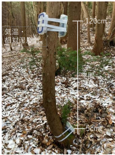
図-2 斜面下部における空間線量計、 気温・相対湿度計の設置状況
